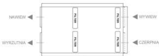
Centrala serii VW – wersja wykonania: lewa (widok od strony inspekcyjnej)
